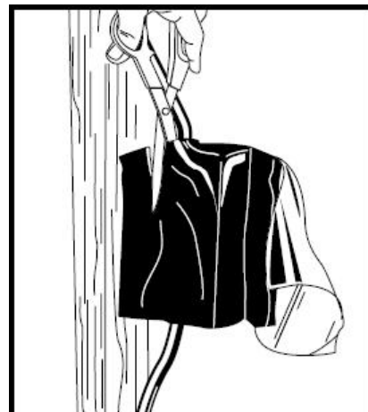
4. Knip of snij al het overige materiaal weg. Uw brandwerende wandcontactdoos is gereed.
